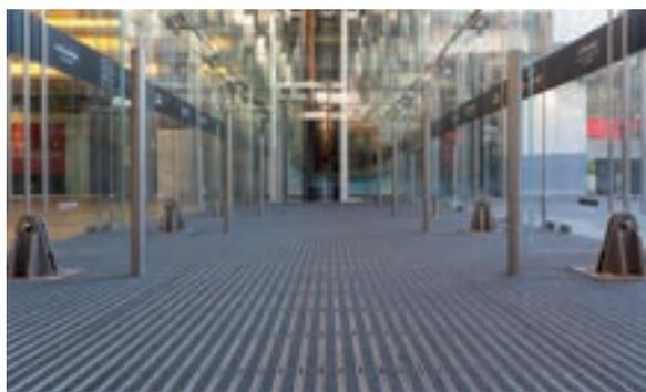
la alfombra. La alfombra Nomad Optima+ Fina está diseñada con perfiles bajos de aluminio que van pegados a un soporte PET cerrado y con relleno textil 3M Nomad Aqua 85. Se puede colocar en el foso sin bordes o bien directamente sobre el suelo con bordes.
